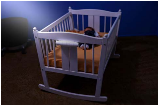
An der Wiege schaukelt Swaybe das Kind auch dann weiter, wenn die Eltern mal eine Schaukelpause brauchen. Foto: Fraunhofer LBF
